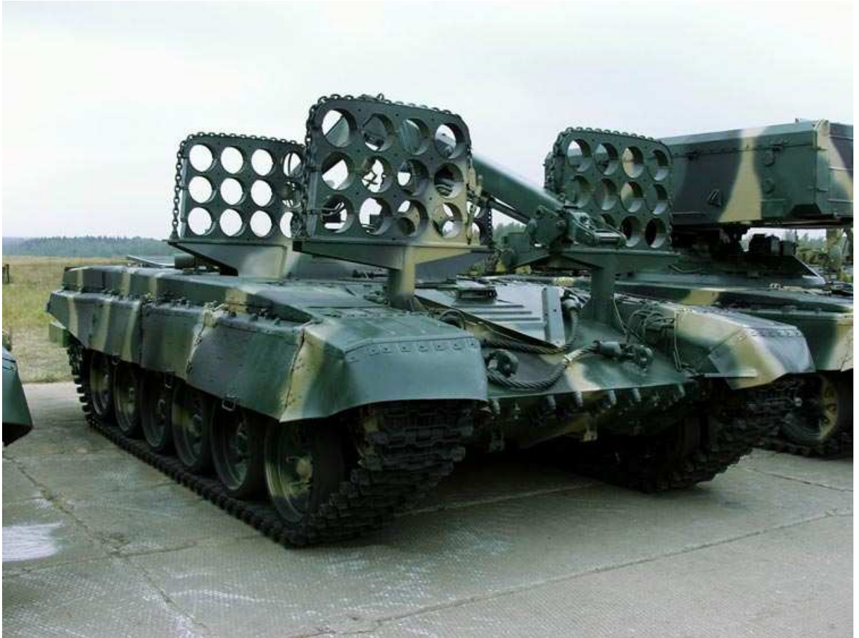
هذه صورة لآلية الشحن التي تتبع الراجمة
