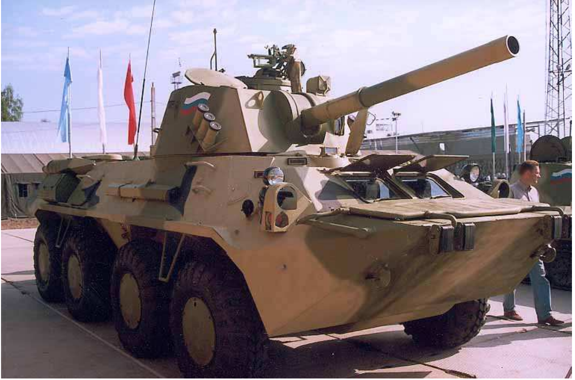
هذه صورة لناقله الجنود المدرعة (ب/ت/ر-80) وقد ركب عليها برج المدفعية (نونا) وهي تقريبا بنفس المواصفات لكن مع قدرة حمل قذائف أكثر
